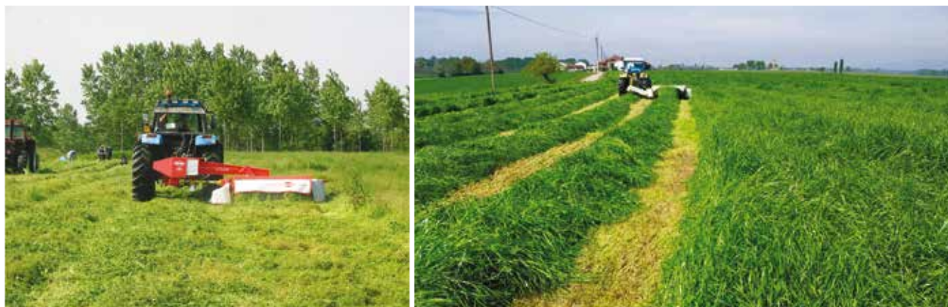
Figure 1 e 2 - A sinistra: sfalcio con falcia condizionatrice azionata dalla presa di potenza; a destra: operazioni di sfalcio per l'insilamento o la fienagione (foto Ernesto Tabacco).
