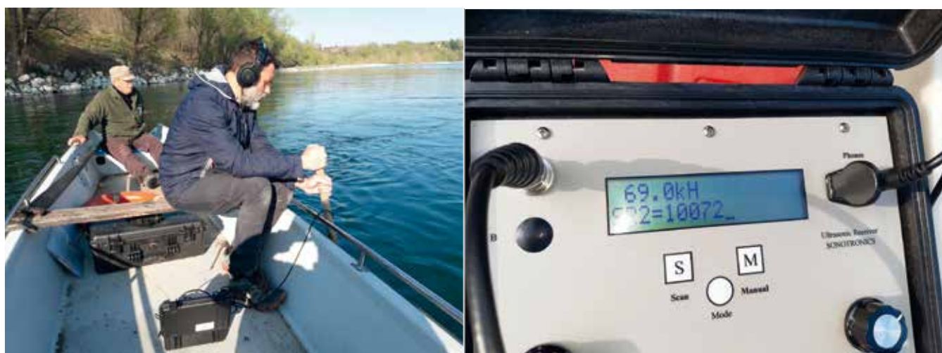
Figura 22 - Attività di biotelemetria eseguita da barca. A destra la lettura sul display del ricevitore del segnale di un trasmettitore, in cui sono indicati la frequenza e il codice identificativo dell'animale.
